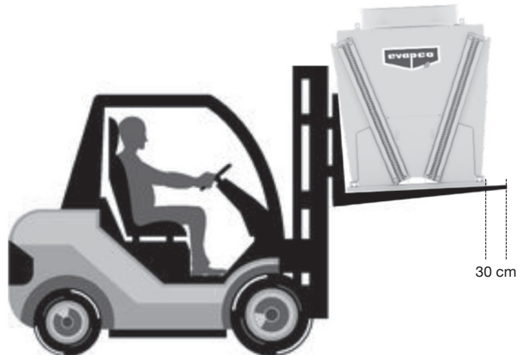
Abb. 12 – Hebeanforderungen an den Gabelstapler bei V-Coil Geräten
