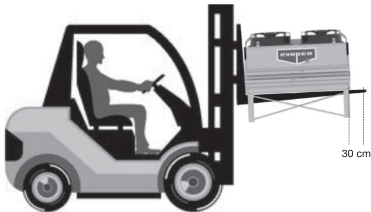
Abb. 4 – Hebeanforderungen an den Gabelstapler bei Tischkühlern
