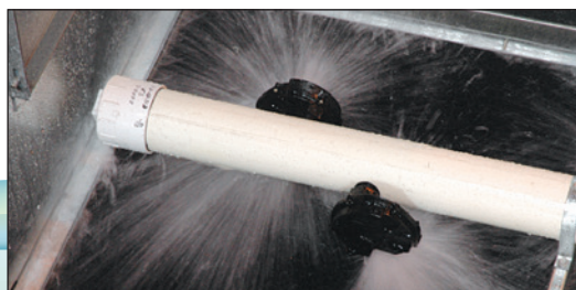
Nuovi ugelli EVAPCO EvapJet™ a confronto con i precedenti ugelli
