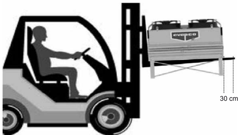
Figure 4 – Exigences relatives au levage par chariot élévateur d'une unité avec batterie à plat
