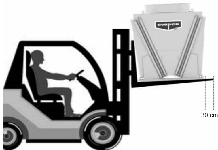
Figure 12 – Exigences relatives au levage par chariot élévateur d'une unité avec batteries en V
