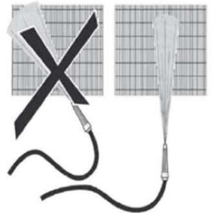
Figure 16 – Nettoyez toujours les ailettes avec un flux vertical
