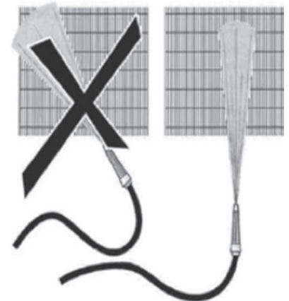
Abb. 1 – Reinigen Sie die Lamellen grundsätzlich in vertikaler Richtung
