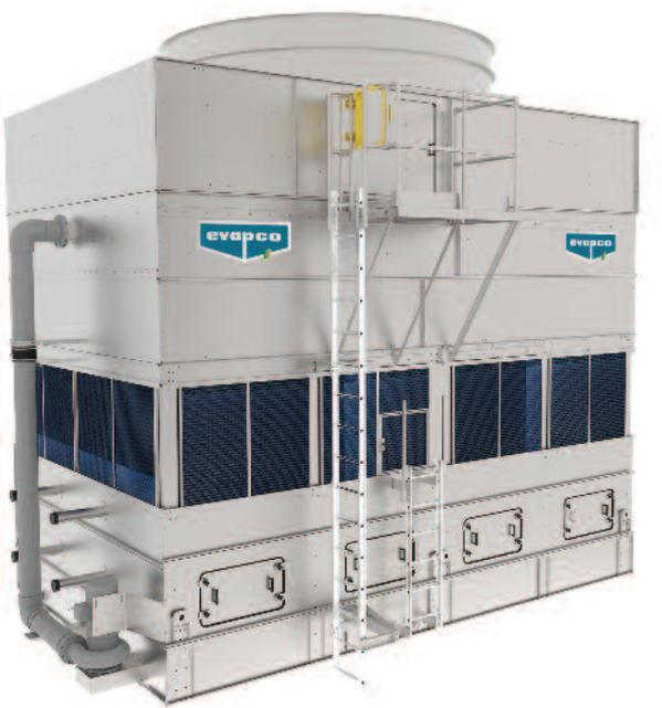
Externe Wartungsbühnen bieten eine stabile Basis für den Zugang zu den Antriebskomponenten, der Wasserverteilung und den Tropfenabscheidern. Die aus schwerem, verzinkten Stahl gefertigte Bühne läßt sich leicht am Aggregat befestigen und bedarf keiner externen Träger. Die optionale Wartungsbühne umfasst eine vertikale Aluminiumleiter und erfüllt alle maßgeblichen OSHA-Anforderungen. Sofern für die Installation erforderlich, ist auch ein Sicherheitskorb für die Leiter erhältlich.
