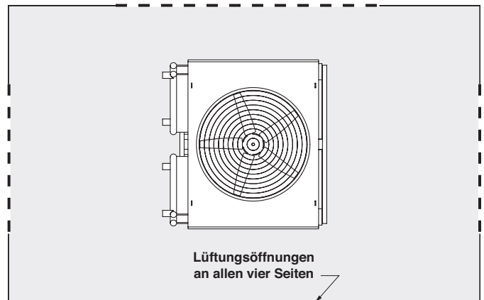
Abb. 20 - Wandumbauten mit Lufteintrittsöffnungen
