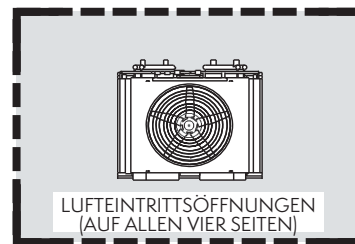
Abb. 7 - Aggregat innerhalb einer Wandumbauung mit Lufteintrittsöffnungen
